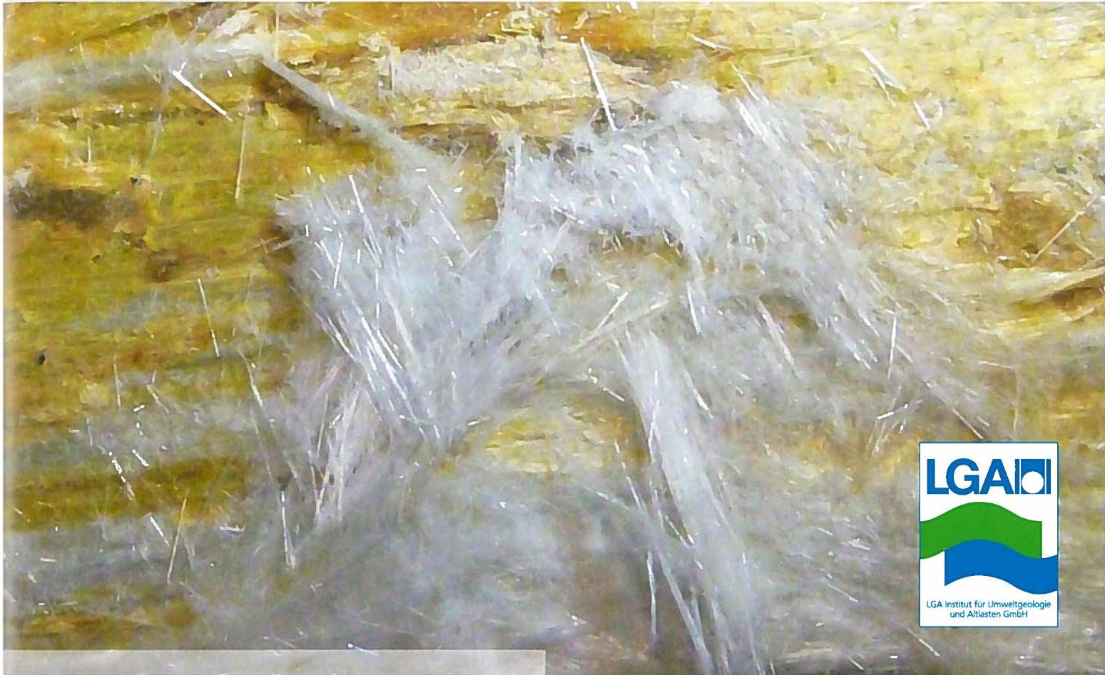
Serpentin-Asbest (Chrysotil) entsteht bei der Metamorphose von Gesteinen. Bei mechanischer Beanspruchung (z. B. Reiben) werden feine Asbestfasern sichtbar, die sich in der Längsachse immer weiter aufspalten können
