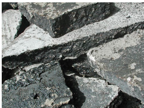
Oben rechts: Teerhaltige Schwarzdecke auf teerhaltig vorgeschwitzter Schottertragschicht
