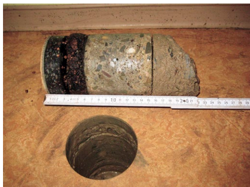
Oben rechts: Asbesthaltiger Bodenbelagskleber
